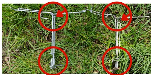
Piège Cauet à gauche, contrefaçon à droite (une boucle de fixation de la goupille)
